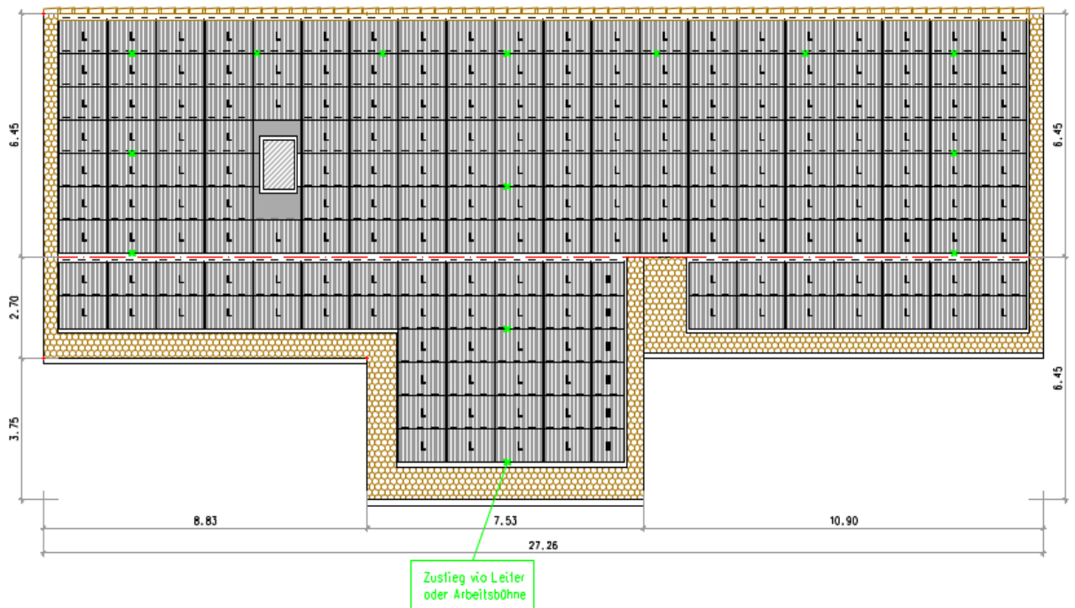
Bild 2: Plan Auslegung Indachanlage, auf der südöstlichen Dachfläche, Alte Landstrasse 5. Total 195 PV-Module, Typ 3S TeraSlate II, mit einer Leistung von 44.388 kWh.
